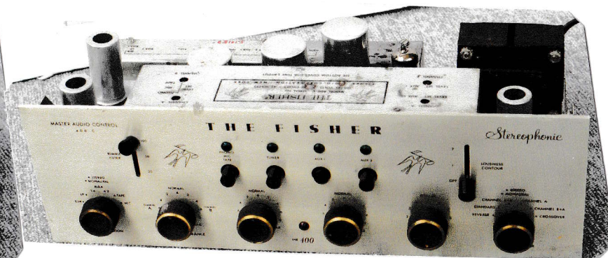
商品番号 162012 400-C STEREO-PRE 真空管STEREO-PRE No.S-10153 12AX7(5751) × 6本 EX8/6V4 1本 12AT7 1本
