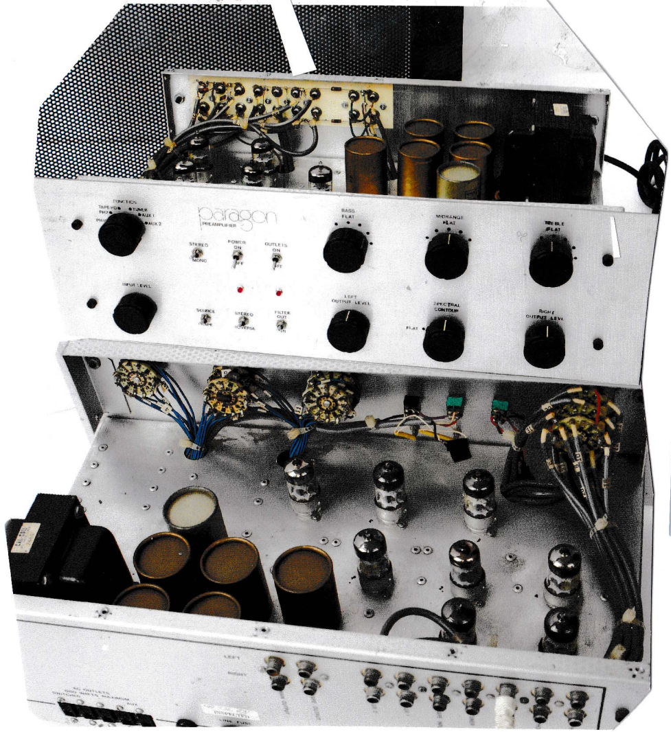
商品番号 162051 PARAGON PREAMP 真空管 極上品 USA-PARAGON 12AX7 8本使用 BASE/MIDRANG/TUREP 3Wayコントロール
